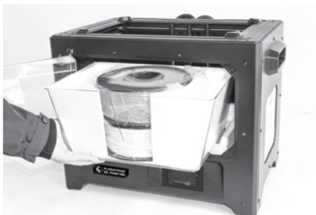
7. 从打印机中取出顶罩及耗材包装，取出耗材。
