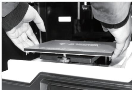
8. 托住打印平台两侧，缓缓将平台从底部抬起，便于取出下方的泡沫盒。
