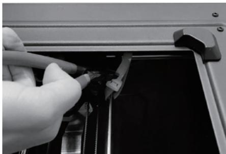
6. 取出装有配件的泡沫盒。剪断左右两边固定X轴的扎带。
