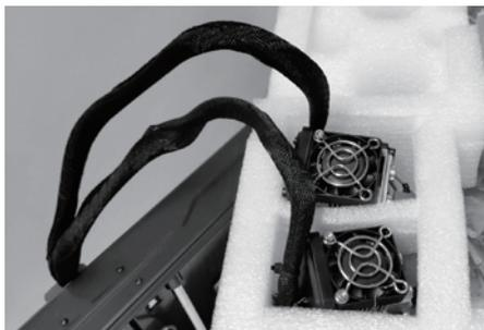
5. 首先将喷头从泡沫中取出，放置在台面上。喷头的线束较短，在摆放时请注意喷嘴不能接触台面，避免划伤喷嘴影响打印精度。
