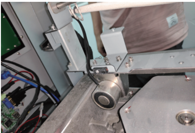
清理X轴后光电开关。
