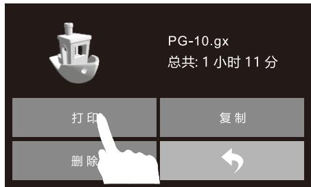
2. 在方块和圆筒文件中选择一个，点击[打印]，打印机会开始加热，加热完毕后自动开始打印。
