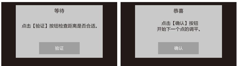
4. 点击【验证】按钮再次验证距离是否合适，若距离合适，点击【确认】进行下一点的调平。若距离仍不合适，请继续按照液晶屏提示操作，直至调平全部完成。
