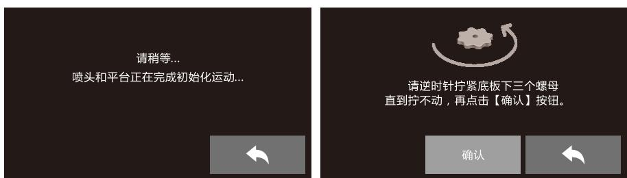
1. 点击触摸屏上依次点击【工具】-【调平】图标，之后根据液晶屏的提示信息进行调平。待初始化运动完成后逆时针拧紧底板下三个螺母直到拧不动，点击【确认】。
